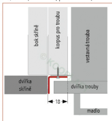
Umístění boční ochranné lišty MT/bocni (levá strana, pohled shora)
