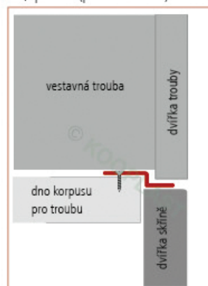
Umístění spodní ochranné lišty MT/spodniS (pohled z boku)
